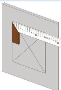
Medir el marco exterior y con ayuda de una falsa escuadra dibujar el perfil de la apertura sobre la pared o sobre el techo en el cual la trampilla será instalada
