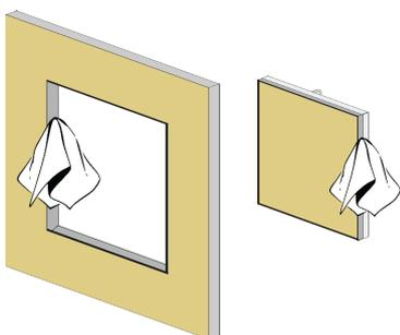
Cubrir atentamente los cierres de click antes de pintar y limpiar eventuales residuos de pintura sobre los dos marcos (interior y exterior). Tener cuidado de no dañar la junta: esta debe quedar intacta después de la instalación.
