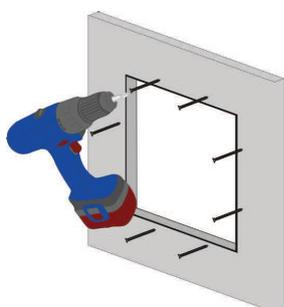
Sostener el marco exterior contra la pared desde el interior y fijarlo a la pared o al techo de placa de yeso, con tornillos autoperforantes a una distancia máxima entre ellos, de 17 cm.
