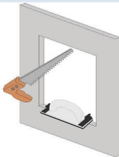
Cortar la apertura de la pared o del techo (con serrucho o sierra de arco).
