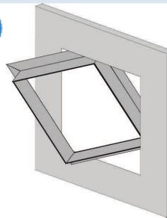
Insertar el marco exterior de la trampilla en la apertura, haciéndolo girar en diagonal hacia el interior del corte realizado. En caso de instalación sobre pared los cierres de click deben quedar la parte superior.
